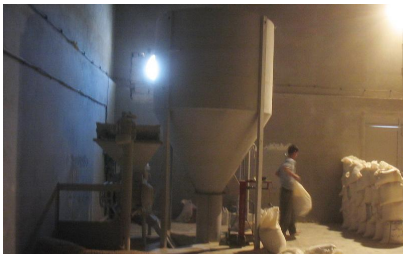
نمونه یک کارخانه خوراک در واحد مرغداری ( آسیاب، میکسر و بالابر )
